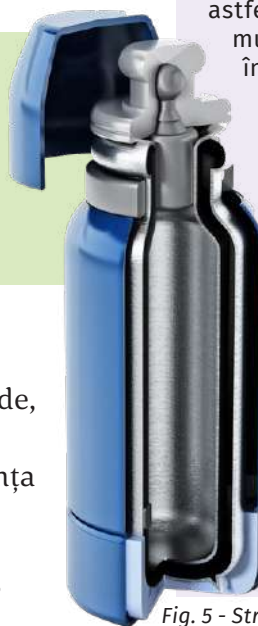
Fig. 5 - Structura vasului Dewar
